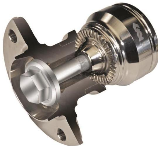
Конструкция торцевого шлица образует положительное зацепление между ступицей колеса и неподвижным шарниром распределительного вала посредством шлица на торце шарнира. Он центрируется с помощью конуса в ступице и прикрепляется к ступице с помощью противоусталостного болта.
